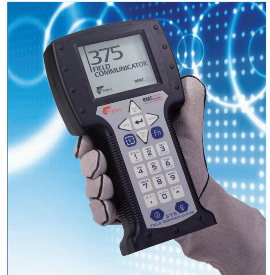
Коммуникатор модели 375 разработан для поддержки любых приборов с протоколами HART и FOUNDATION fieldbus, выпускаемых любыми производителями.
